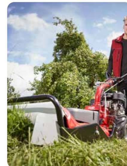
Combi BF 5002-R II LONCIN 196 OHV LC1P70F-3 / 196 cm³. 3,8 kW sterk basismaskin med mange tilleggsmuligheter. Hastighet forover 2,2 km/t, bakover 1,1 km/t. Vekt 45 kg. Varenr. 127 766 Veil. pris kr. 13.300,-
